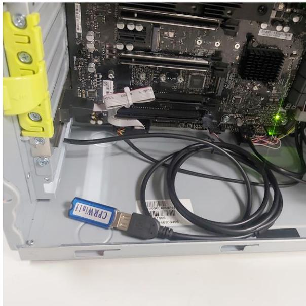
Step3：延長線的另一端插在主機後置 USB 埠上，鎖上機殼側板，避免遺失。
